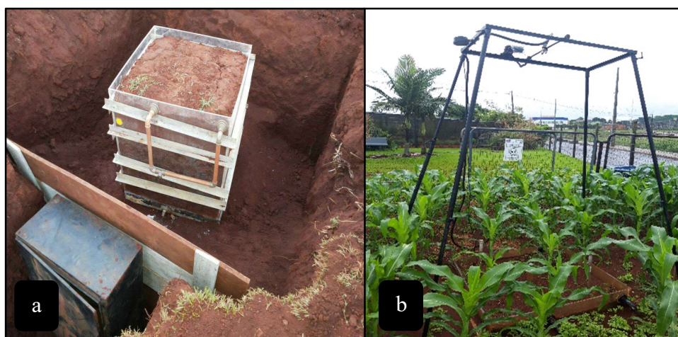
Figura 3 - Tubulação instalada no lisímetro de percolação para amostragem de escoamento superficial e percolado (a) e simulador de chuva utilizado no presente estudo (b). Fonte: O Autor, 2020.
