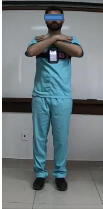
Figura 13 - Posição do smartphone na região do osso esterno, fixado com sistema elástico ao redor da caixa torácica.
