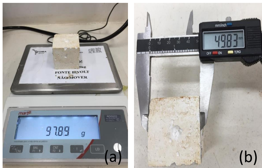
Figura 11. Corpo de prova sendo pesado e medido suas arestas para cálculo de massa específica.
