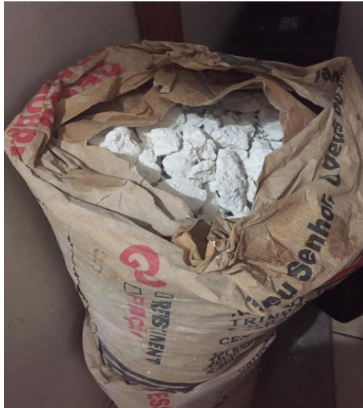
Figura 3. Resíduo de gesso proveniente de revestimento.
