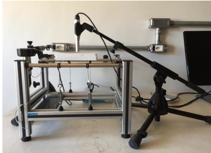
Figura 14. Passo a passo da técnica de excitação por impulso.
