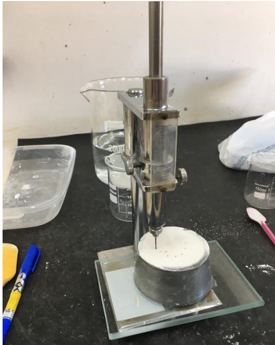
Figura 7. Aparelho de Vicat para determinação de tempo de início e fim de pega.
