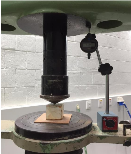
Figura 12. Ensaio de Dureza superficial no momento de aplicação de carga.
