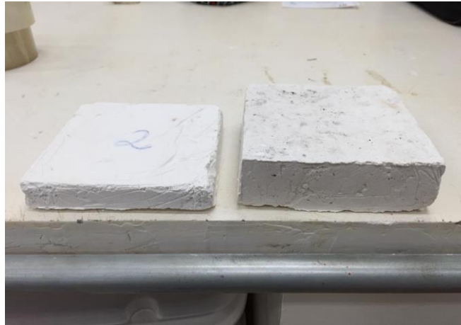
Figura 17. Placas para ensaio acústico de 20 e 40 mm de espessura.
