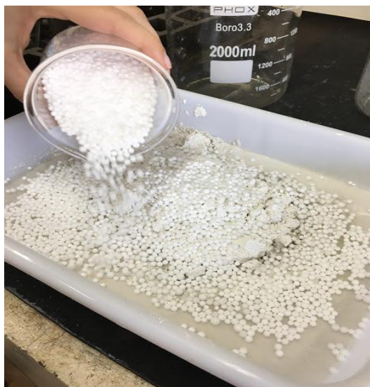
Figura 8. Pérolas de poliestireno expandido sendo acrescentadas durante hidratação do pó de gesso.
