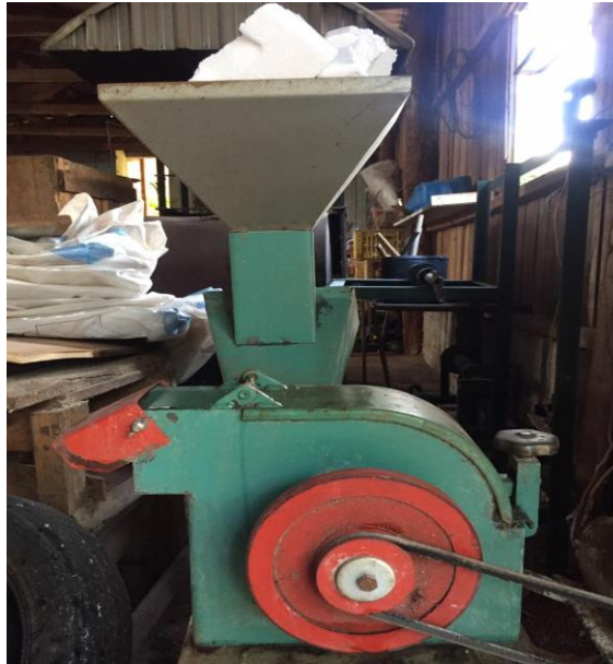
Figura 5. Resíduo de EPS sendo triturado em triturador de grãos.
