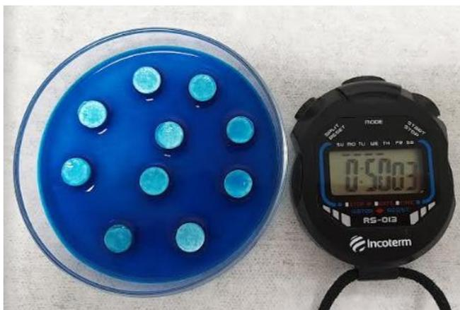
Figura 29 Teste de absorção de água no comprimido orodispersível.
