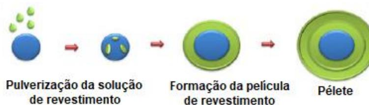
Figura 7 Revestimento de núcleo inerte a partir da pulverização de uma solução de revestimento.
