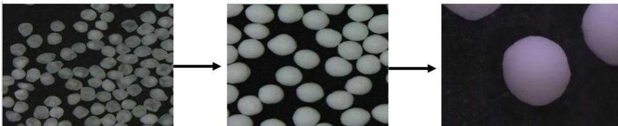
Figura 27 Péletes de omeprazol após aplicação da suspensão de revestimento.
