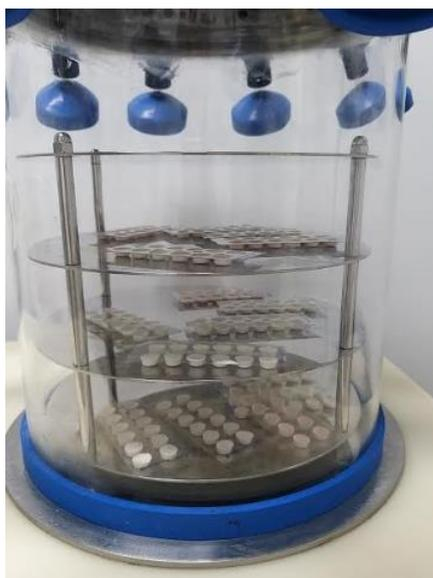
Figura 21 Liofilização dos comprimidos orodispersíveis.
