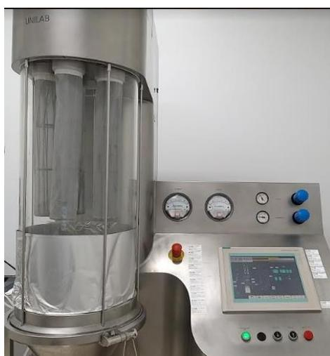
Figura 17 Leito fluidizado para revestimento de péletes.
