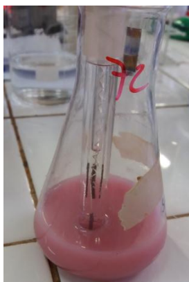
Figura 9. Determinação de Atividade Lipolítica- Método Titulométrico. (Fonte: Autor, 2019).
