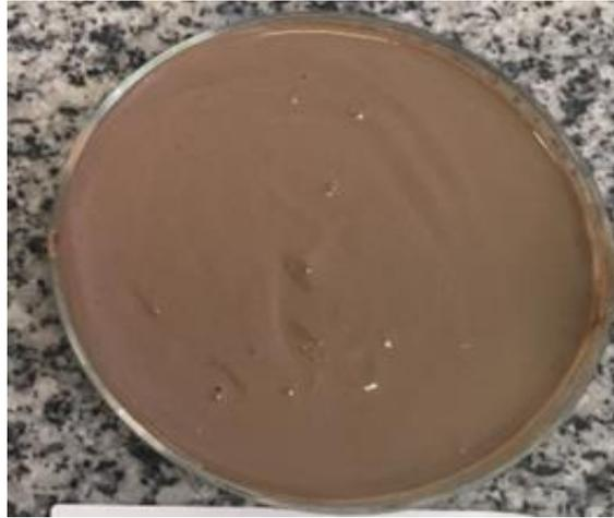
**Figura 4.5** - Hidrolisado proteico de fígado suíno a partir da enzima Alcalase 2.4 L®, temperatura 64°C, pH 6,4
