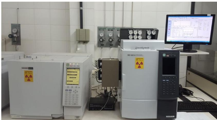
**Figura 56:** Cromatógrafo gasoso com Detector de Condutividade Térmica utilizado para avaliação da formação de hidrogênio gasoso ( $H_2$ ). (Fonte: Autoria própria, 2018)
