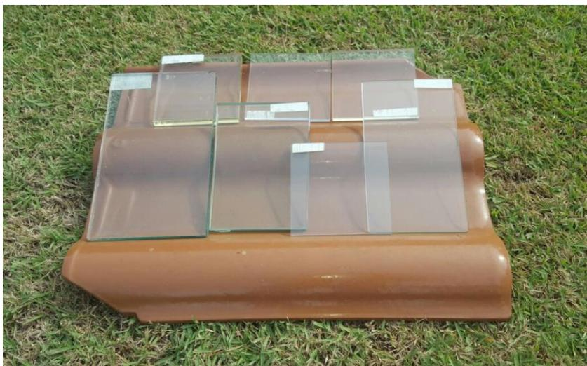
**Figura 52:** Amostras de materiais translúcidos expostos às condições metereológicas.
