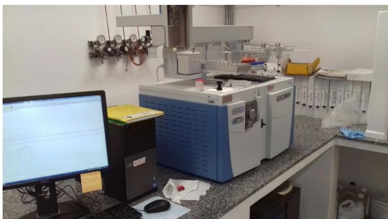
**Figura 41:** Cromatógrafo gasoso utilizado para identificação dos compostos orgânicos voláteis presentes nos gases das graxarias. (Fonte: A autoria própria, 2018)
