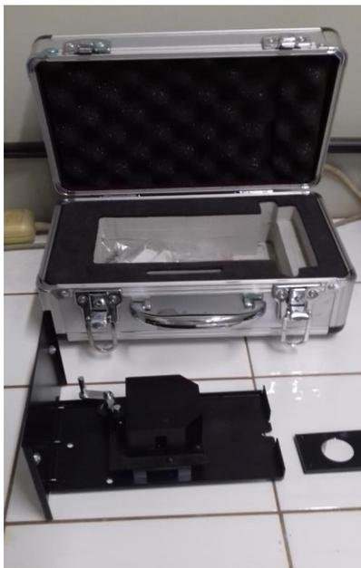
**Figura 50:** Acessório de medição de reflectância utilizado no espectrofotômetro. (Fonte: Autoria própria, 2018)
