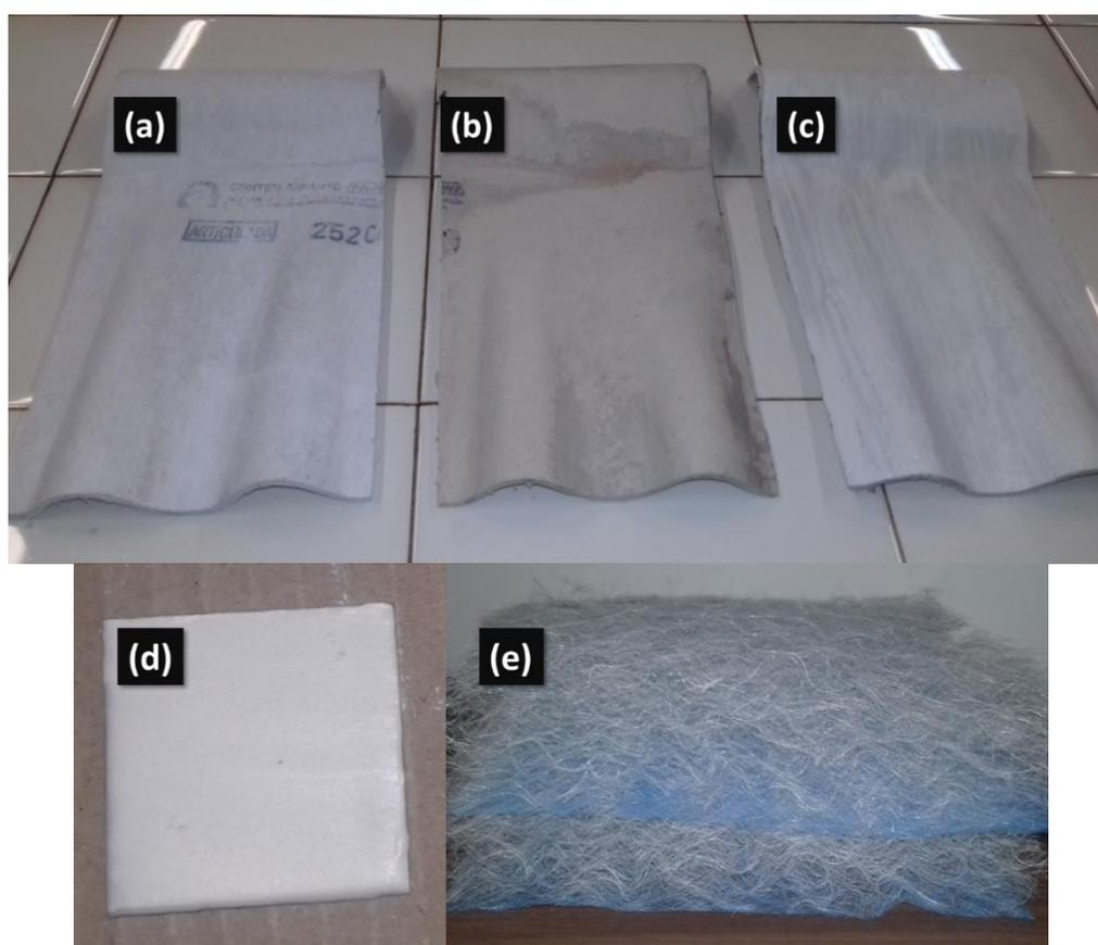
**Figura 48:** Superfícies fotocatalíticas utilizadas nos experimentos de oxidação: (a)  $\text{TiO}_2$  + fibrocimento, (b) tinta Fotosan® + fibrocimento, (c) tinta acrílica + fibrocimento, (d) Tinta PU + suporte metálico; (e)  $\text{TiO}_2$  + fibra de vidro. (Fonte: Autoria própria, 2018)
