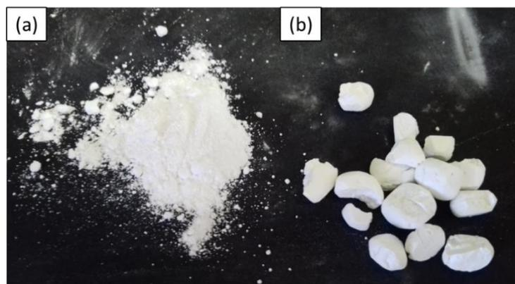
**Figura 47:** (a) Tinta poliuretana em pó após processo de abrasão, e (b) tinta seca em fragmentos sólidos. (Fonte: Autoria própria, 2018)
