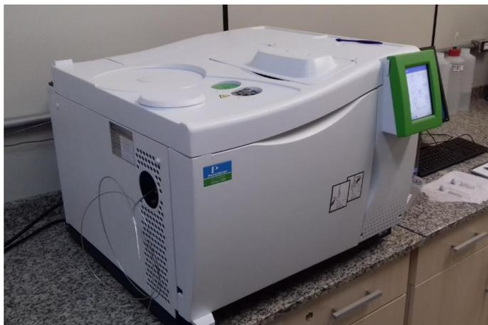
**Figura 40:** Imagem do equipamento de cromatografia gasosa com TCD utilizado para caracterização dos gases gerados. (Fonte: A autoria própria, 2018)
