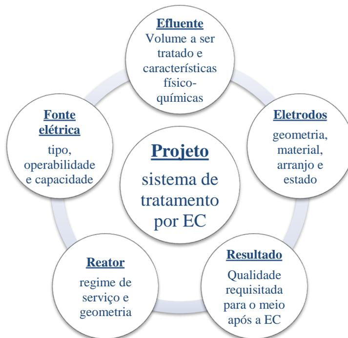
**Figura 1.** Síntese de conhecimentos necessários ao projeto de um sistema de tratamento de efluentes por EC.
