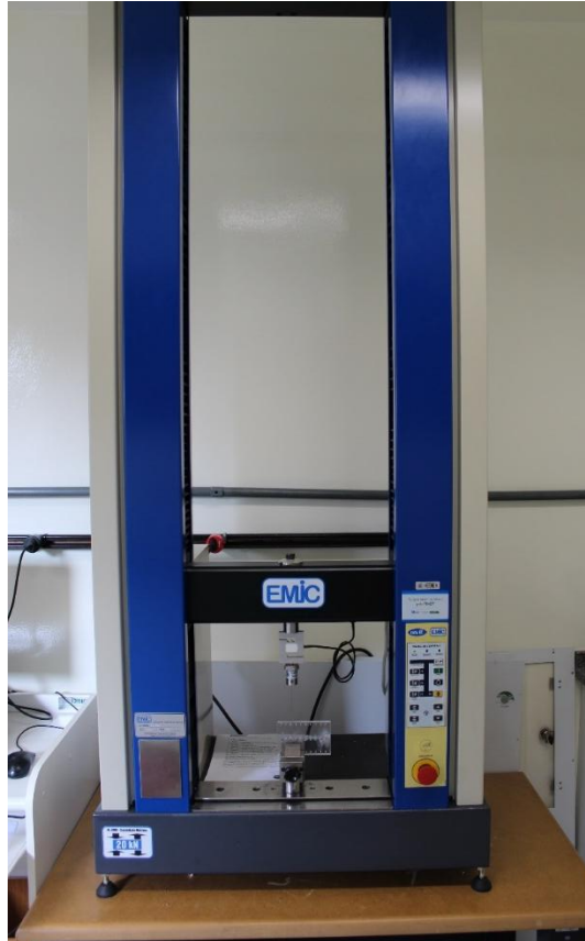
Figura 5 – Máquina de ensaios universal EMIC DL 2000 pertencente ao Laboratório da Pontifícia Universidade Católica (PUC, Curitiba, Paraná).
