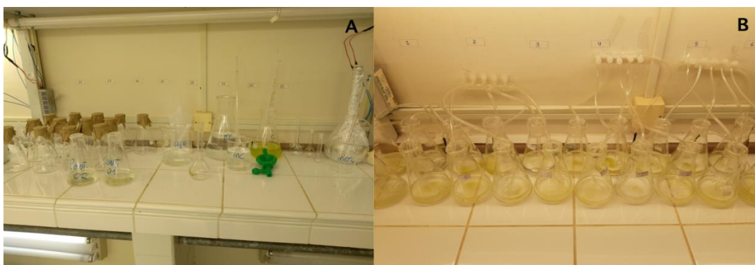
Figura 6. Fotografias da montagem do teste crônico com microalga. A) Preparo das soluções-teste. B) Teste sob luz e aeração constantes.
