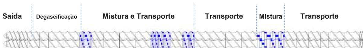
**Figura 6** Esquema de montagem dos elementos de roscas e sua função no processo de extrusão a quente.
