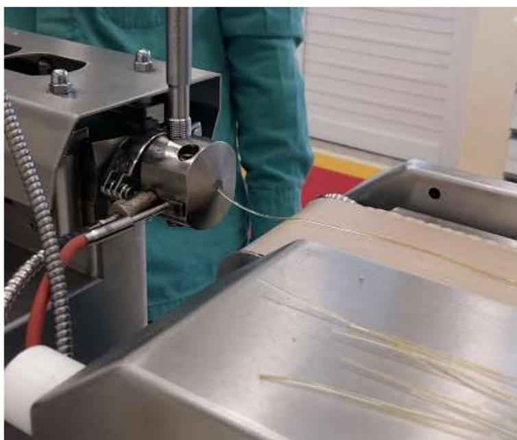
**Figura 12** Material extrusado saindo pela matriz da extrusora.
