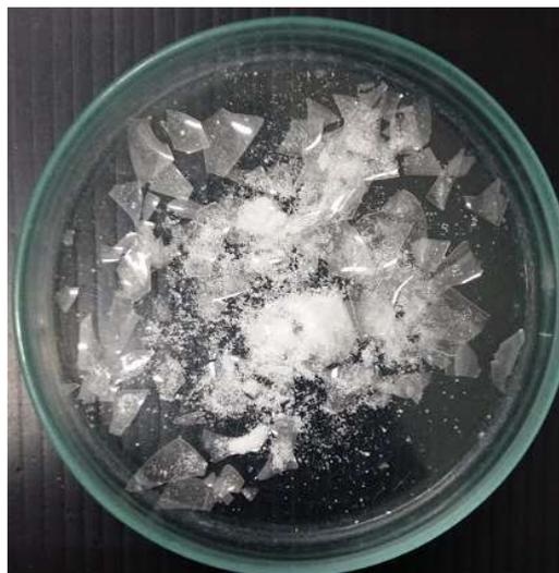
**Figura 25** *Film casting* obtido após secagem e aplicação de vácuo, já retirado da placa de teflon, com aspecto translúcido.
