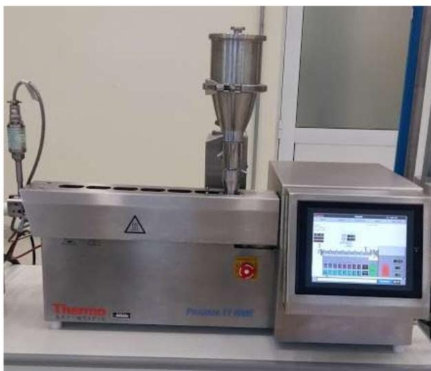
**Figura 9** Extrusora da marca Thermo Scientific Pharm, modelo 11HME.
