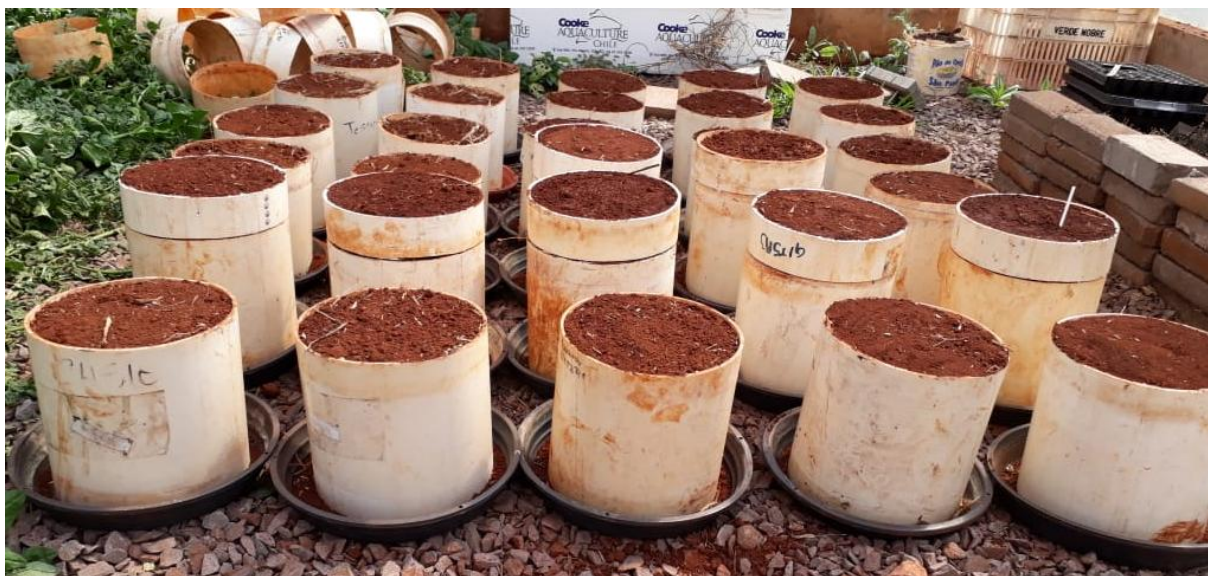
Figura 4, Canos de PVC sendo montados, contendo o cano de 20 centímetros abaixo do cano de PVC de 5 centímetros.
