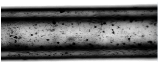
Figura 7 – Imagem obtida por microscópio ótico da fibra de vidro sem a camada polimérica e revestimento da camada
