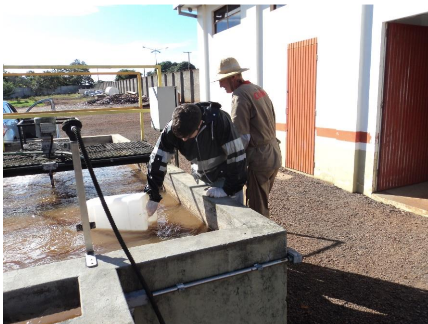
Figura 3. Ponto de coleta do efluente bruto na recepção da ETE.
