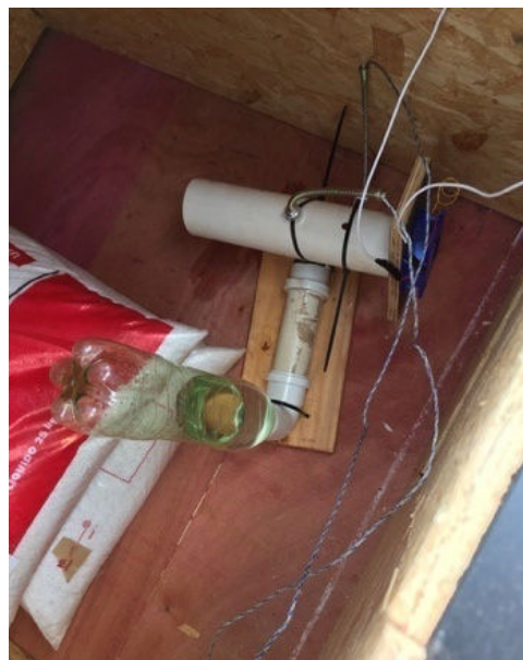
Figura 14: Detalhe de funcionamento do psicrômetro aspirado montagem final
