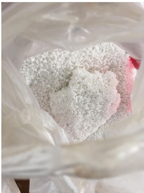
Figura 20: Empedramento do fertilizante próximo à válvula de fechamento.
