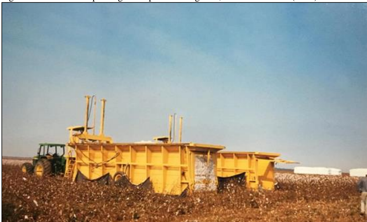
Figura 31: Processo de prensagem da pluma do algodão, Fazenda Divisão (1993).
