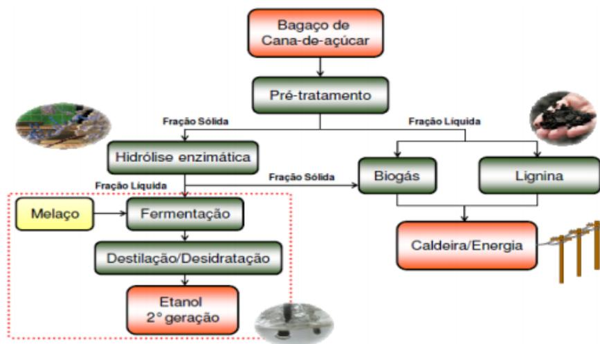
**Figura 5** Fluxograma da produção de etanol de segunda geração.
