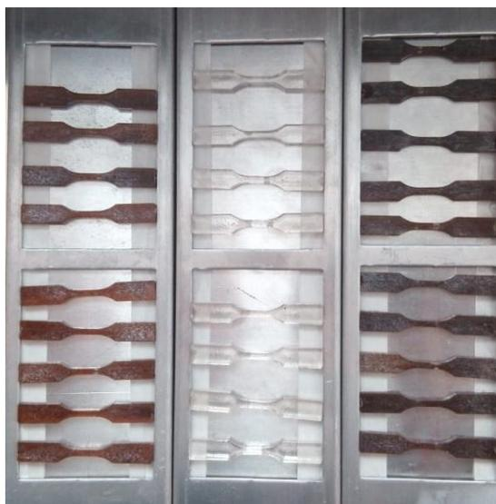
**Figura 6:** Disposição dos corpos de prova nos porta-amostras da câmara de UV.
