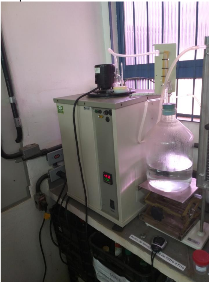
Figura 11 - Aparelho de determinação do ponto de entupimento de filtro a frio utilizado.
