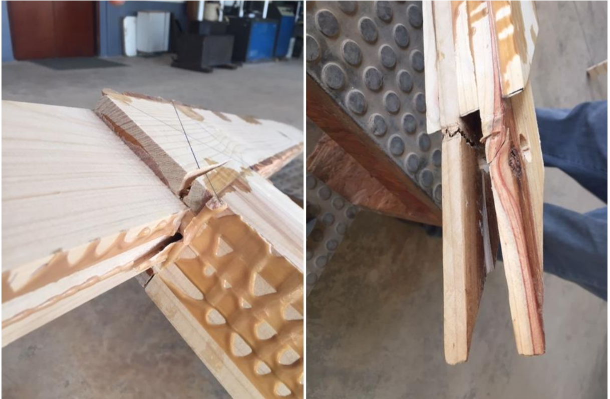
Figura 19 - Detalhe de Ruptura nos nós C e E na estrutura do ensaio 01, pórtico 01
