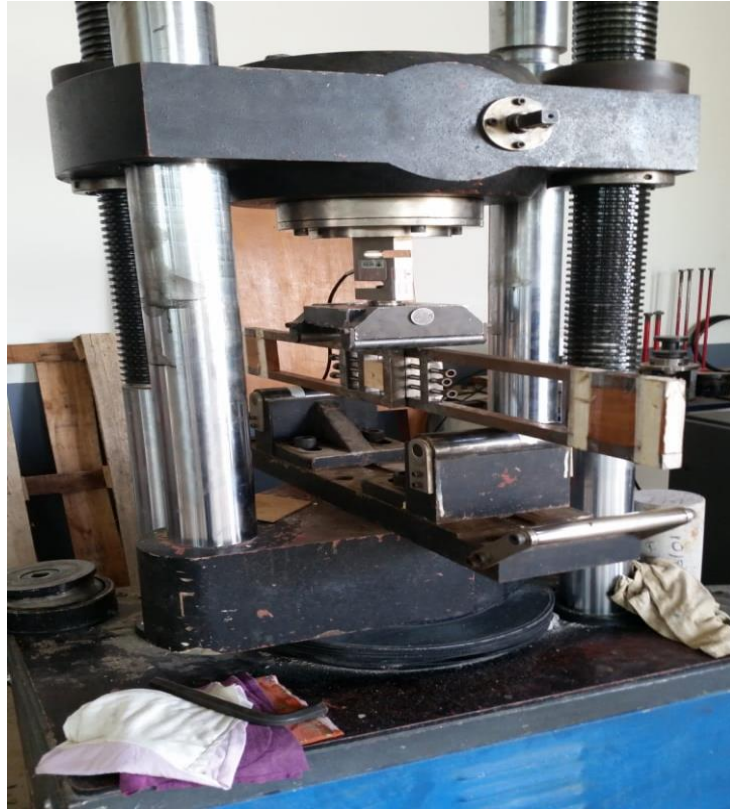
Figura 3 - Ensaio de cisalhamento na torção com o aparato na Máquina Universal de Ensaio
