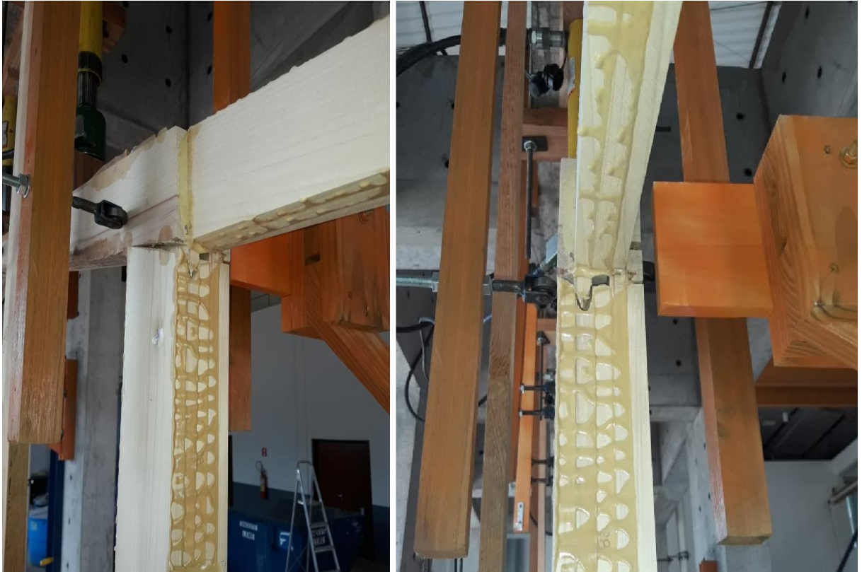
Figura 21 - Detalhe de Ruptura no nó C na estrutura do ensaio 03, pórtico 03
