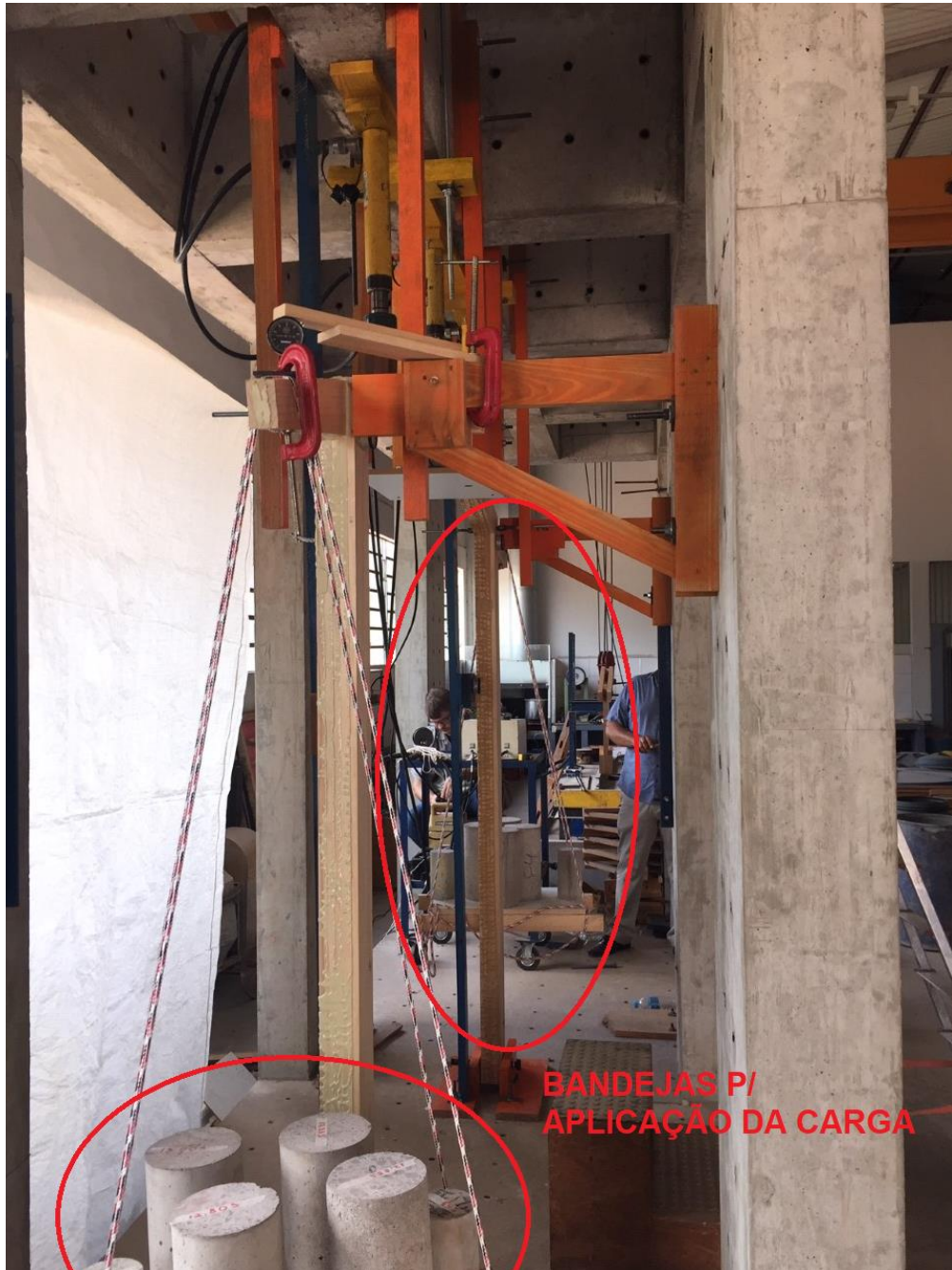
Figura 16 - Detalhe das bandejas utilizadas para aplicação das cargas nos beirais.
