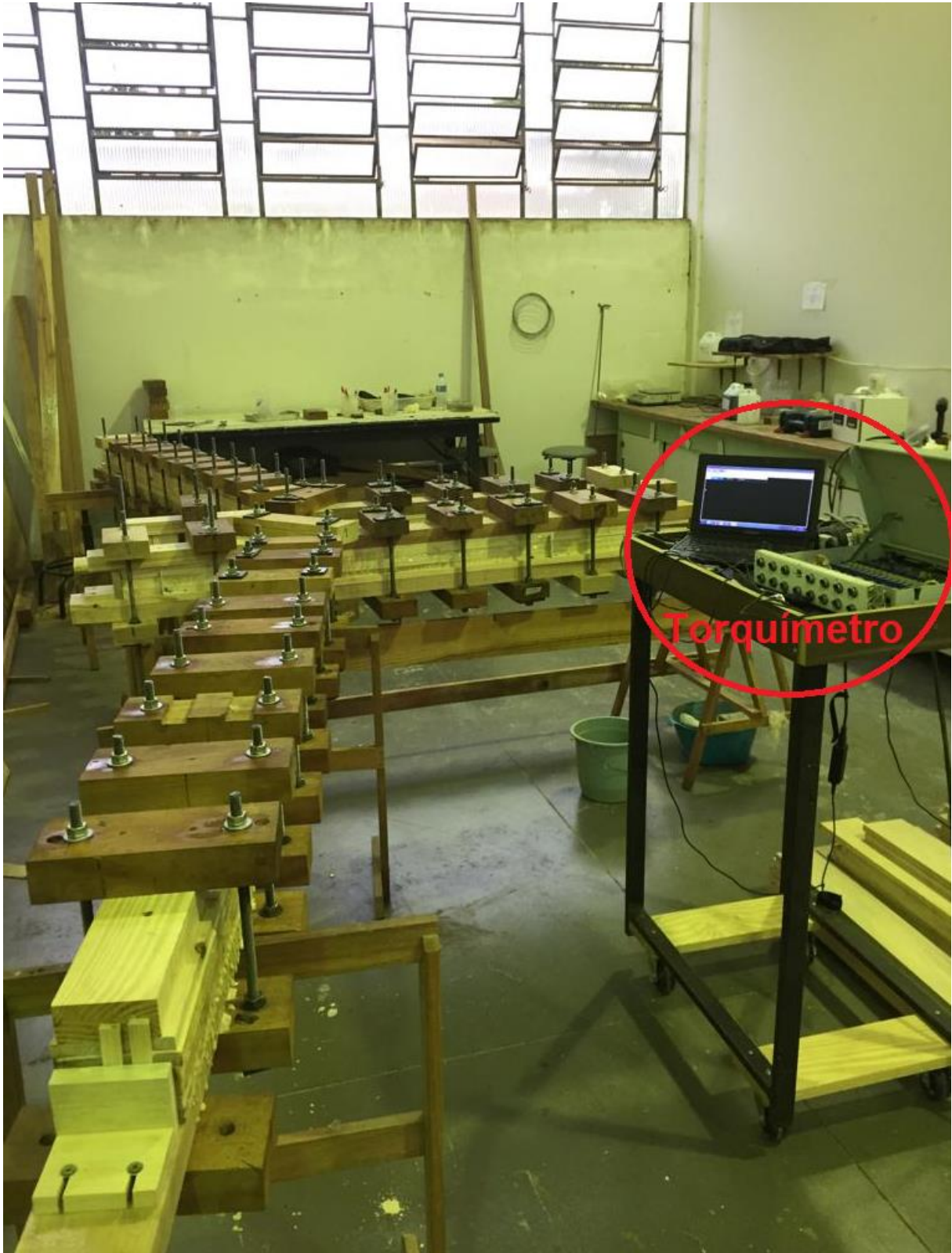
Figura 15 - Gabarito de Colagem e torquímetro eletrônico para controle da pressão
