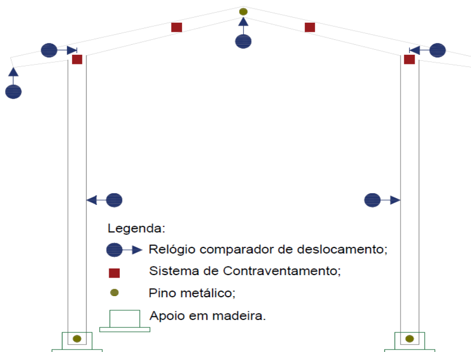
Figura 18 - Esquema de montagem do aparato de teste.
