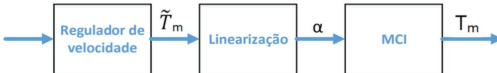
Figura 4.27: Esquema de linearização da válvula borboleta.
