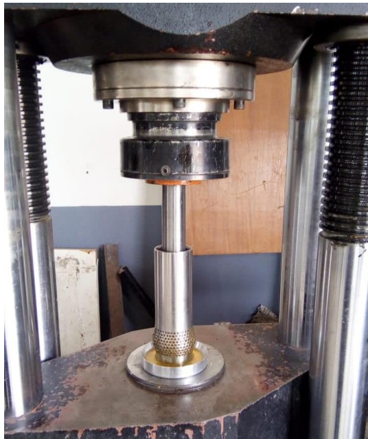
Figura 3 Prensa mecânica adaptada para extração de óleo de linhaça.
