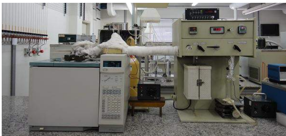
Figura 9. Unidade experimental de reforma a seco utilizada nos ensaios reacionais, acoplada ao espectrômetro de massas ao lado esquerdo.
