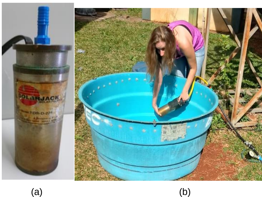
Figura 25. Motobomba. (a) Bomba do tipo submersa marca Solarjack (b) colocação da bomba na caixa d'água.
