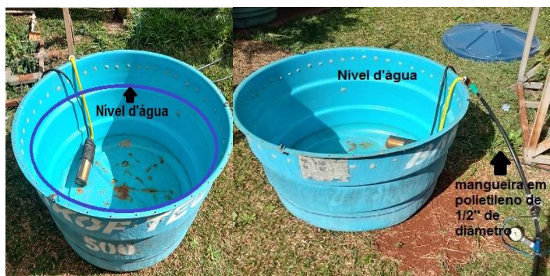
Figura 26. Reservatório de água utilizado. (a) demarcação do nível d'água empregado (b) mangueira que interliga o sistema motobomba com o sistema de irrigação.
