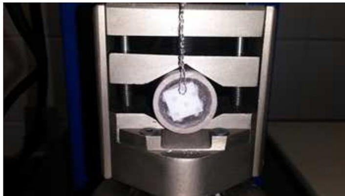
Figura 12 - Vista frontal do cilindro de resina acrílica contendo as amostras, posicionado na máquina de ensaio.
