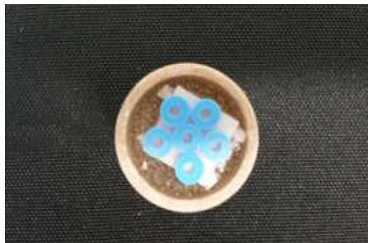
Figura 9 - Posicionamento das matrizes de látex sobre o bloco de resina.
