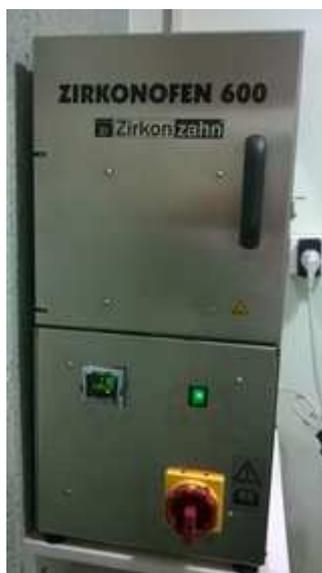
Figura 6 - Forno para sinterização Zirkonofen 600.
