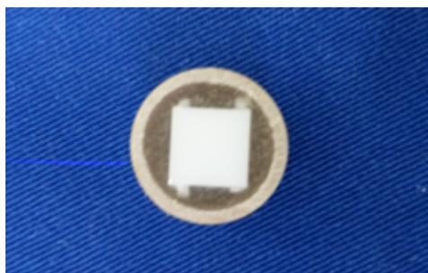
Figura 8 - Bloco de Y-TZP incluído em resina acrílica no tubo de PVC.
