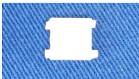
Figura 7 - Bloco de Y-TZP sinterizado mantendo os *sprues*.
