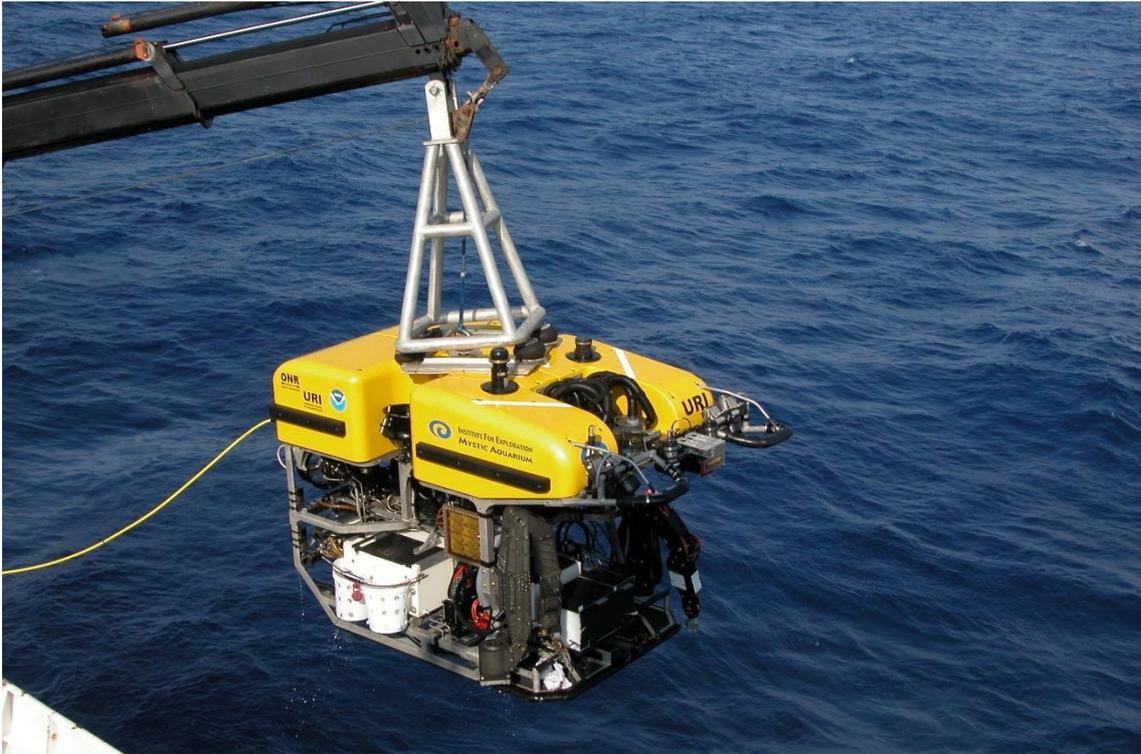
Figura 2.1: Veículo Subaquático Remotamente Operado (VSRO).
