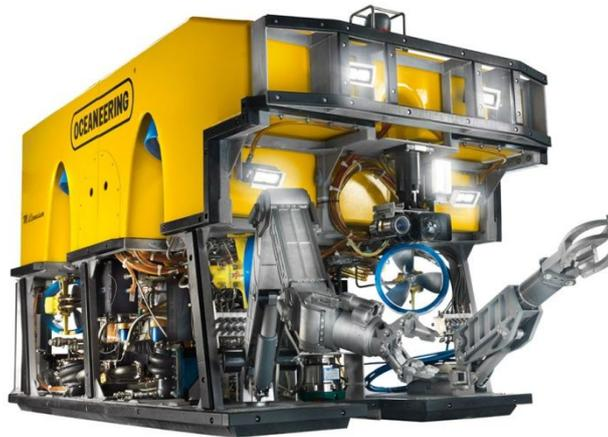
Figura 2.4: Veículo Subaquático com Sistema manipuladores.
