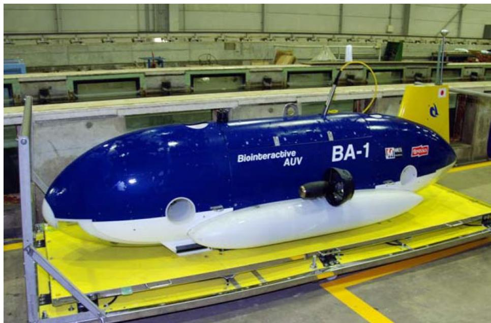
Figura 8.1: Veículo Subaquático autônomo Biointeractive-1.
