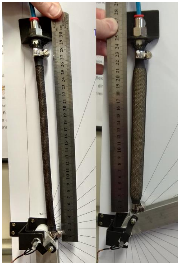
Figura 3.6 - Músculo Pneumático nas posições Estendido e Contraído
