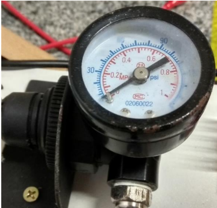
Figura 3.7 - Válvula reguladora de pressão pneumática
