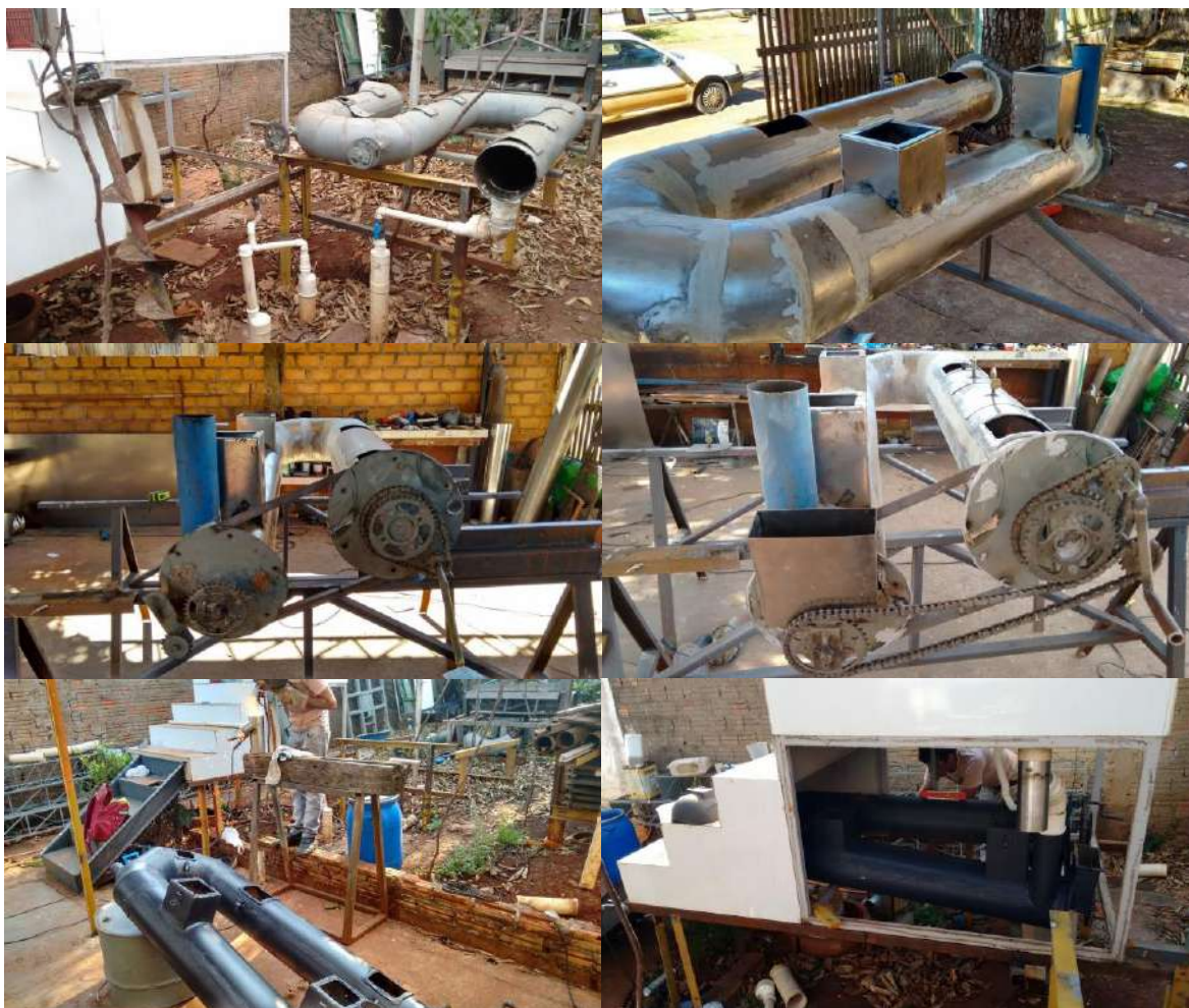
Figura 72: Detalhes Construtivos e Instalação do Protótipo do BAH – Versão 3.0. Fonte: Elaborada pelo autor (2017).
