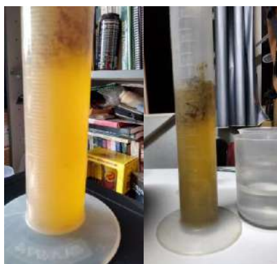
Figura 16: Método Gravimétrico para Obtenção da Massa Específica das Fezes Humanas.
