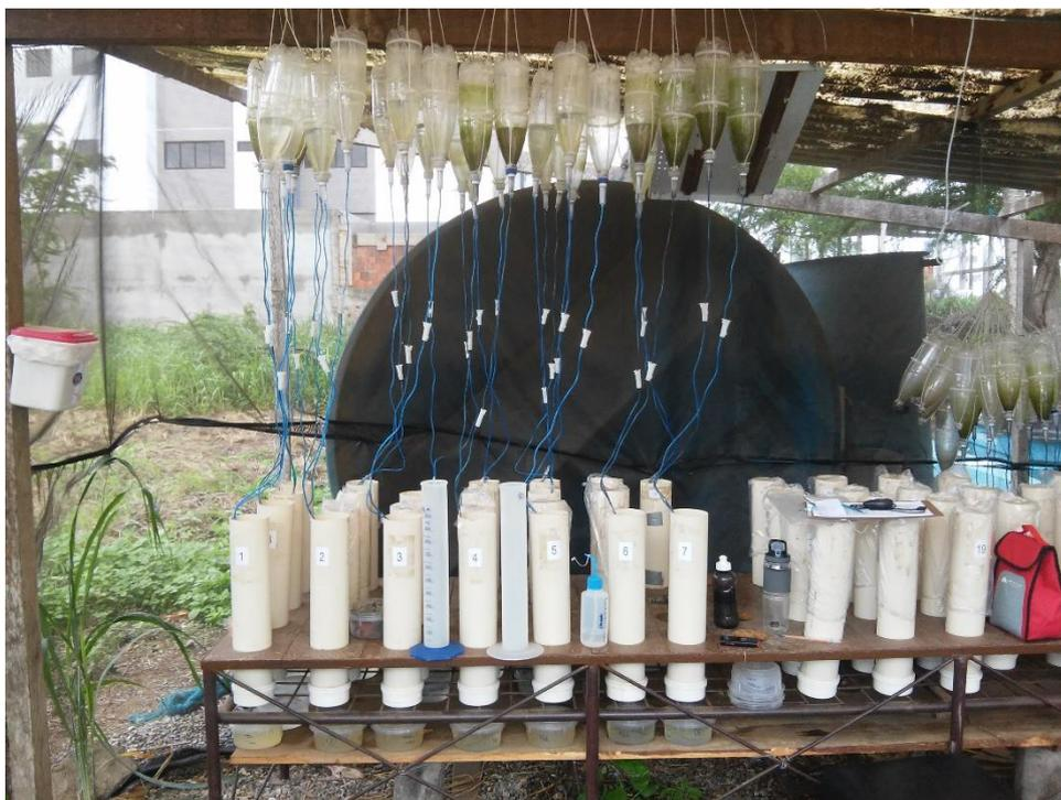
Figura 8 Ensaio de lixiviação com as colunas de solo.
