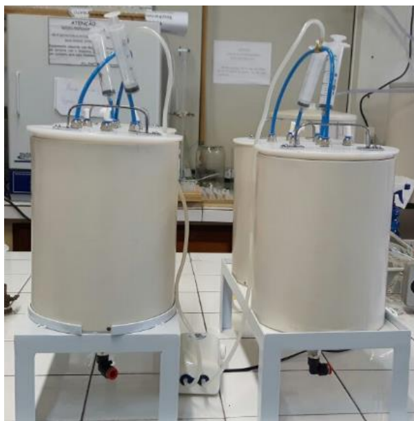
Figura 3.4: Reatores utilizados na Fermentação Acética pelo Método de Orleans Modificado com adição de O_2 .
