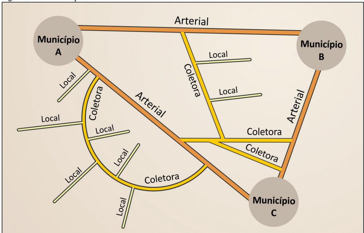
Figura 2 – Classificação funcional da malha rodoviária.
