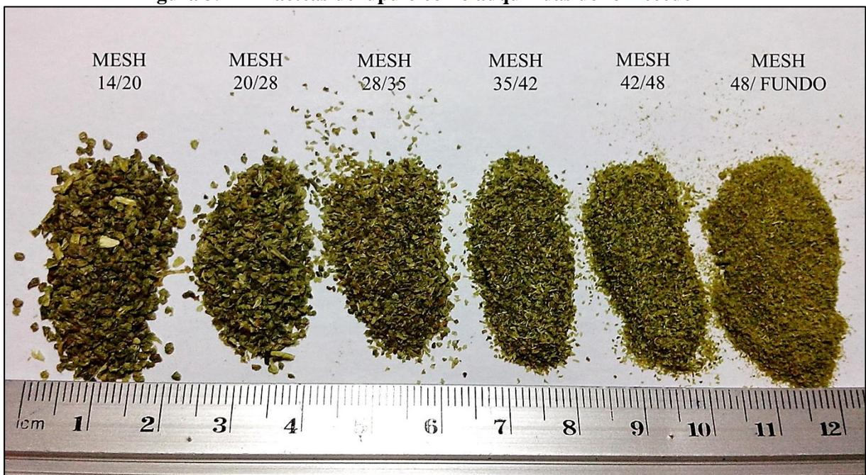
**Figura 3.3 – Pellets de lúpulo após moagem e classificação**
