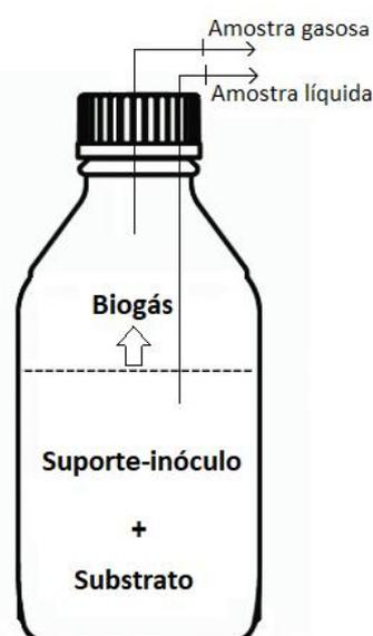
Figura 3.1: Aparato experimental para os ensaios preliminares de pequena escala.
