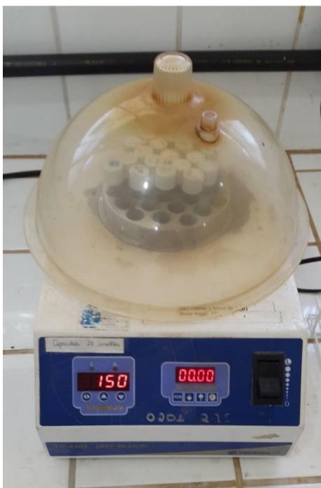
Figura 11 - Análise de DQO pelo método colorimétrico de refluxo fechado.
