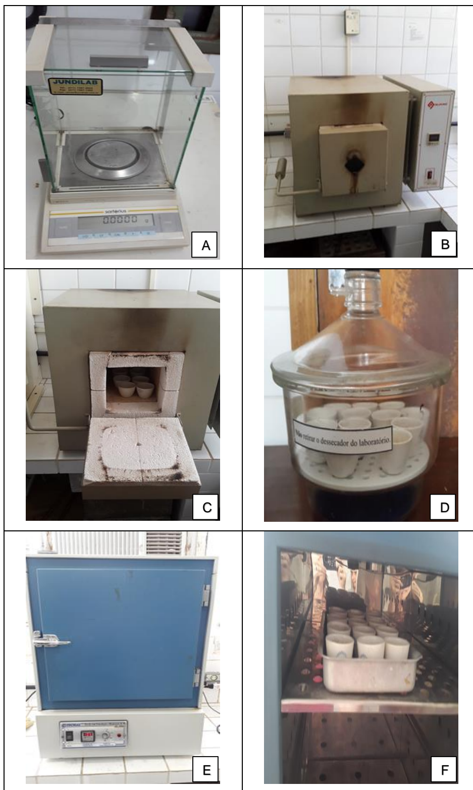
Figura 12 - Equipamentos e procedimentos para análise de sólidos - balança analítica modelo BP 221S marca Sartorius (A); forno mufla Quimis (B); cadinhos dentro da mufla (C); cadinhos no dessecador para posterior pesagem (D) estufa com circulação e renovação de ar modelo TE – 394/1 marca TECNAL (E) e cadinhos para secagem em estufa (F).
