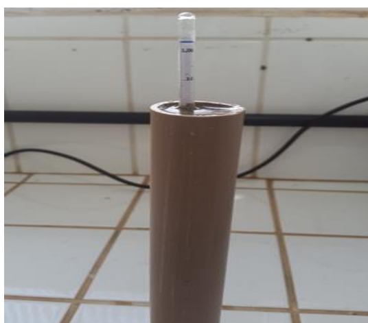
Figura 15 – Leitura da densidade da amostra com o uso do densímetro.
