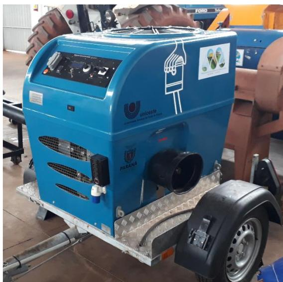
**Figura 10** - Dinamômetro EGGERS, modelo PT170.
