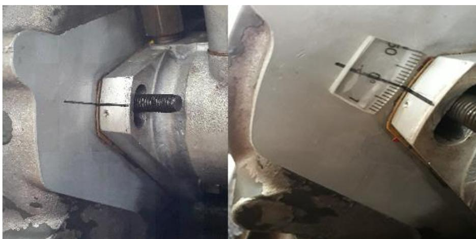
**Figura 8** – Referência genuína do ponto inicial de injeção, com adequação para o ajuste mecânico da bomba injetora.
