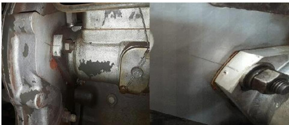
**Figura 7** – Referência genuína do ponto inicial de injeção da bomba injetora.
