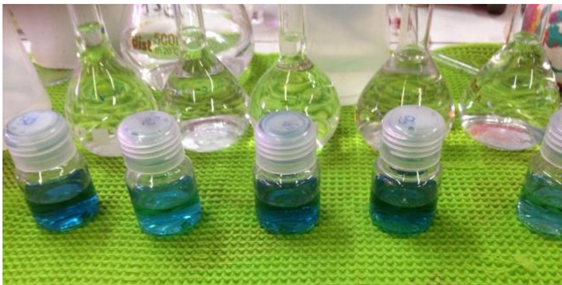
Figura 15: Amostras de Solução de Sulfeto de Sódio após a realização do teste Alfakit sem a adição de nanopartícula.
