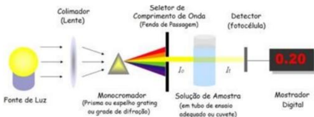
Figura 9: Espectroscopia uma visão do sistema.
