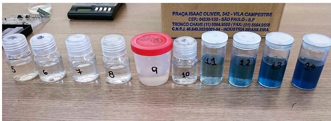
Figura 25: Análise de Adsorção onde 5 é a solução menos concentrada 14 a mais concentrada, adicionado a nanopartícula, através do teste de azul de metileno.
