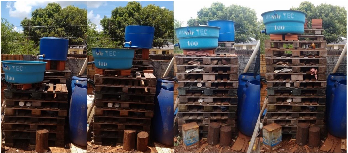
Figura 2 Variação de altura da caixa d'água (1,20, 1,40, 1,60 e 1,80 m). Fonte: Elaborado pelo autor.
