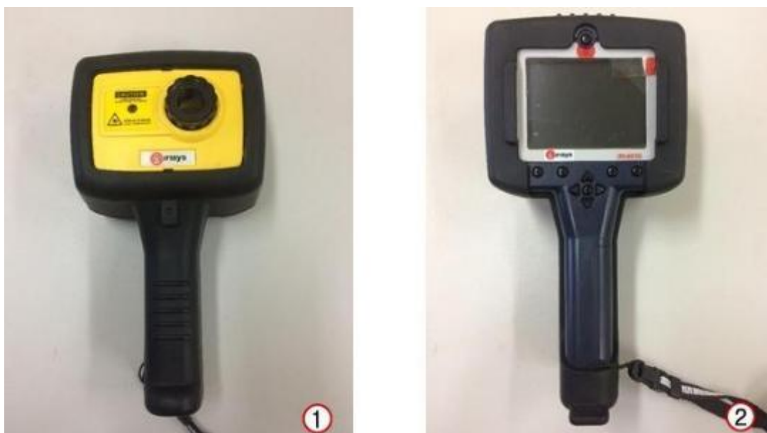
Figura 63: Termovisor Irisys IRI 4030 (1) Vista frontal do equipamento (2) Vista posterior do equipamento.
