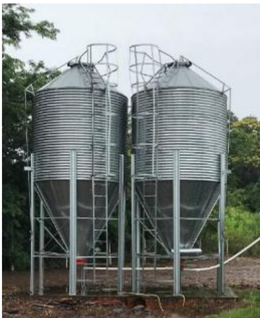
Figura 56: Sistema de nutrição – Silos Avioeste – Capacidade 16 toneladas.
