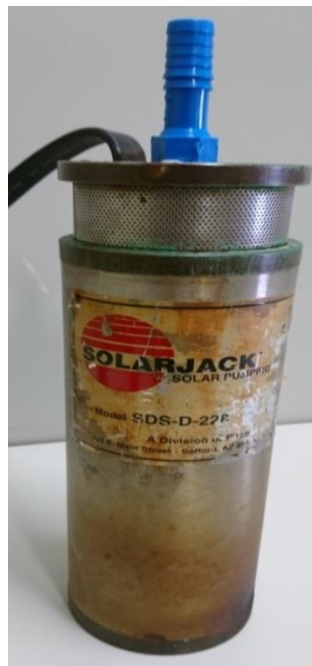
Figura 15. Bomba d'água submersa, marca Solarjack.
