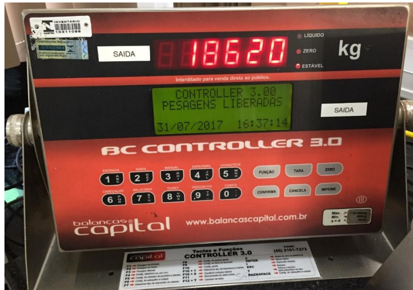
Figura 19. Indicador de pesagem – balança rodoviária capital modelo CONTROLLER 3.0.
