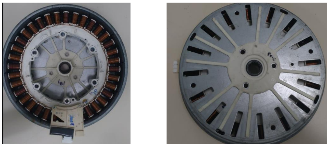
Figura 26 - Motor de Corrente Alternada com Imãs Permanentes
