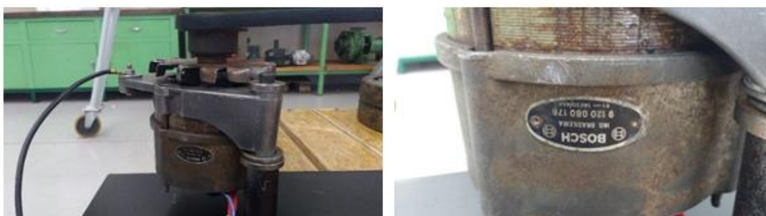
Figura 28 - Modelo gerador CA tipo alternador automotivo Fonte: Dal Ponte, 2017
