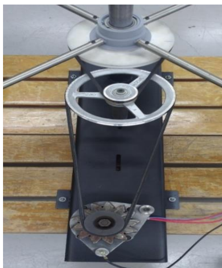
Figura 20 - Conjunto de ampliação de rotação alternador automotivo
