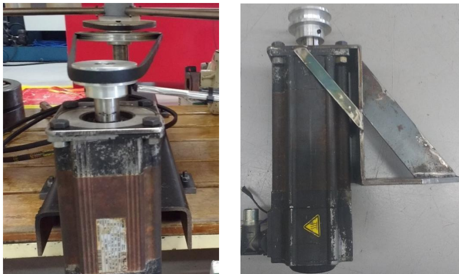
Figura 19 - Conjunto de ampliação de rotação servomotor
