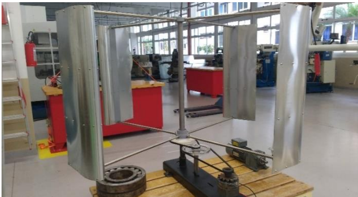
Figura 17 - Aerogerador de Eixo Vertical Fonte: Dal Ponte, 2017.
