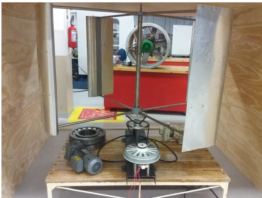
Figura 40 - Sistema de geração utilizando motor máquina de lavar
