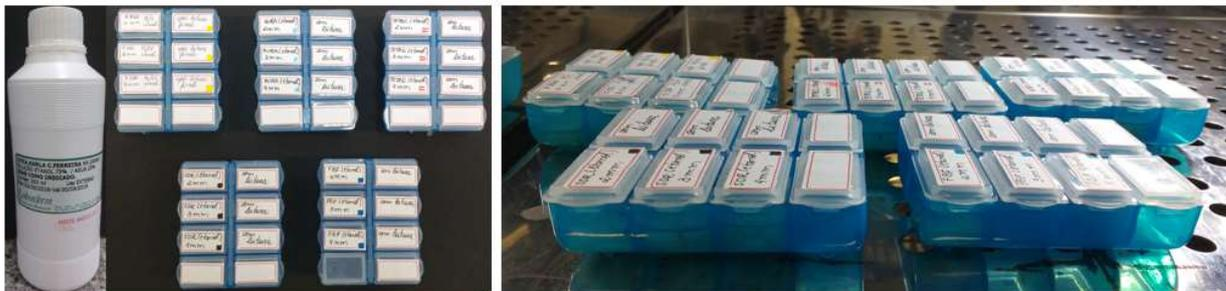
Figura 5– Identificação e armazenamento dos CP em solução de etanol em estufa
