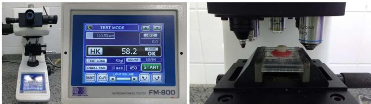
Figura 4 – Microdurômetro com especificações e realização de medidas no CP
