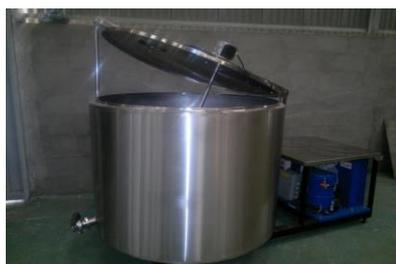
Tanque de aço inox para a recepção do leite coletado nas propriedades.
