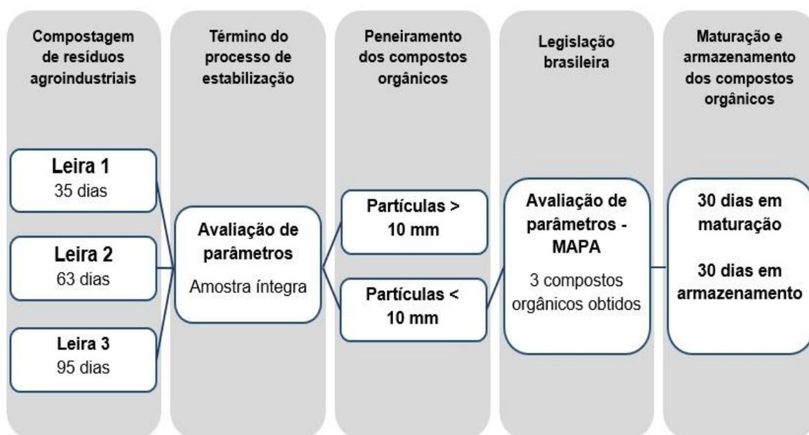
Figura 1 Fluxograma da estrutura geral do experimento.
