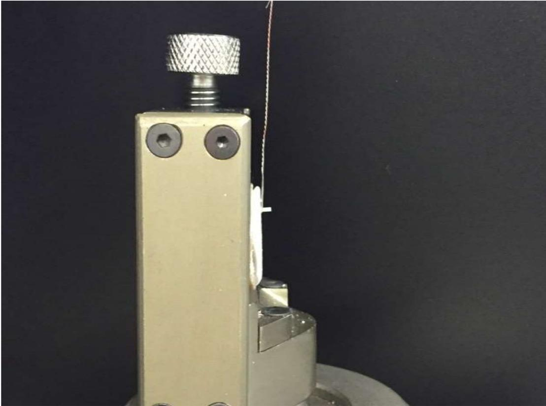
Anexo 19 – Vista lateral de um corpo de prova posicionado no suporte para teste de microcisalhamento.
