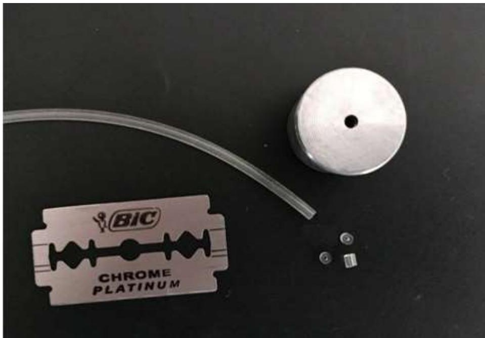
Anexo 10- Dispositivo para corte padrão, lâmina de corte e matriz de Tygon.
