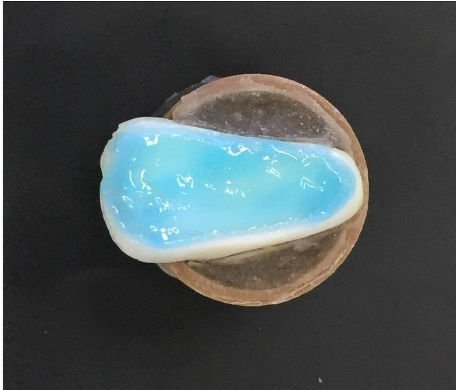
Anexo 11 – Corpo de prova com a aplicação de ácido fosfórico 37%.
