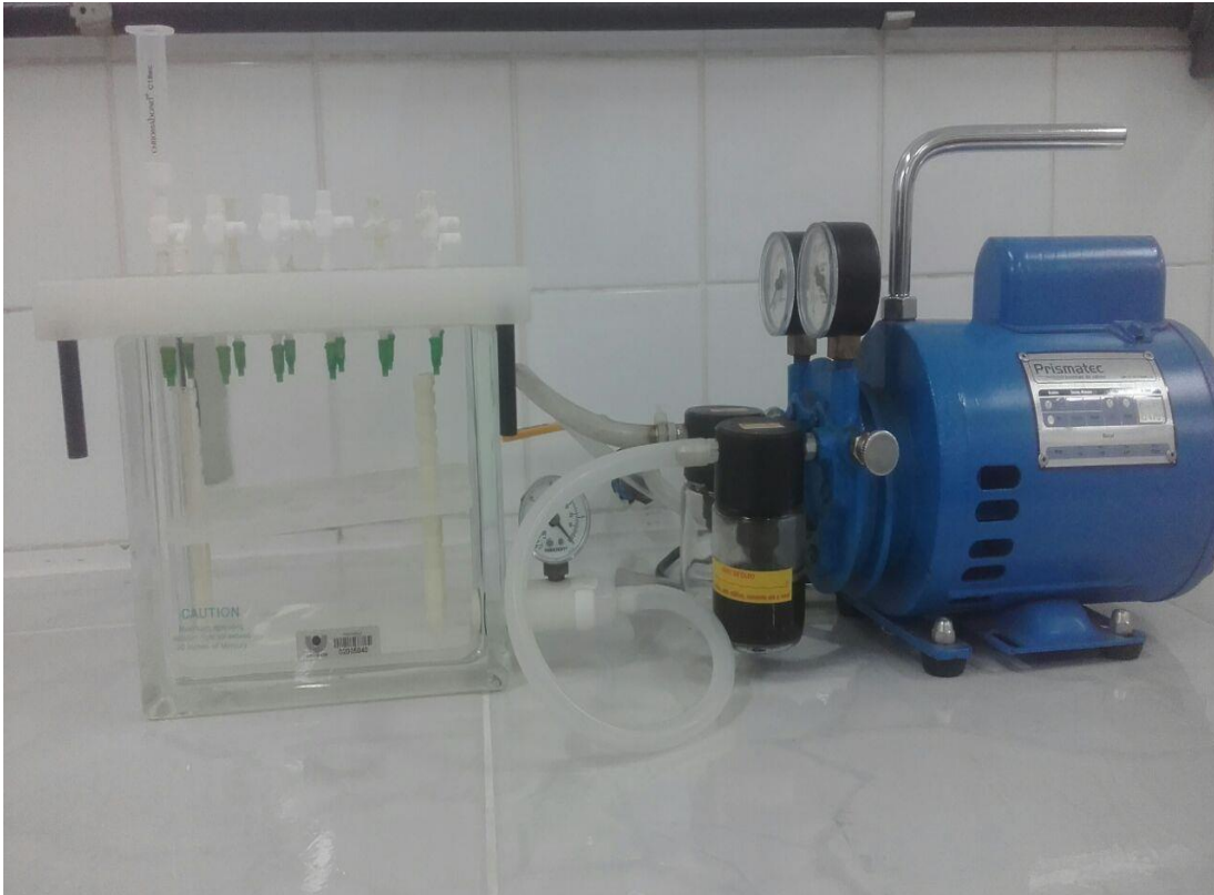
Figura 6 Sistema de extração em fase sólida (SPE). Fonte: Autor (2018)
