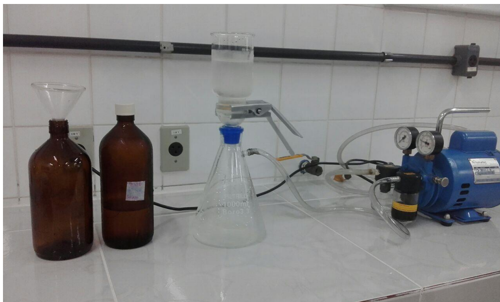
Figura 5 Filtração inicial das amostras para eliminação de interferentes. Fonte: Autor (2018)
