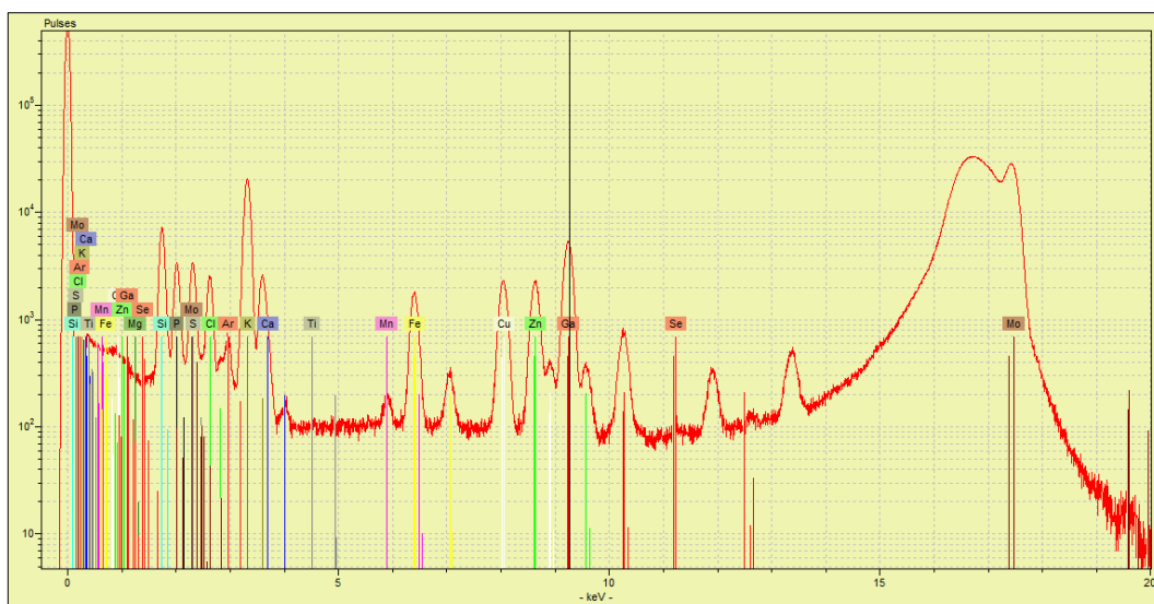
Figura 4.3 - Espectro de TXRF para amostra de Fígado bovino (MRC 1577c).
