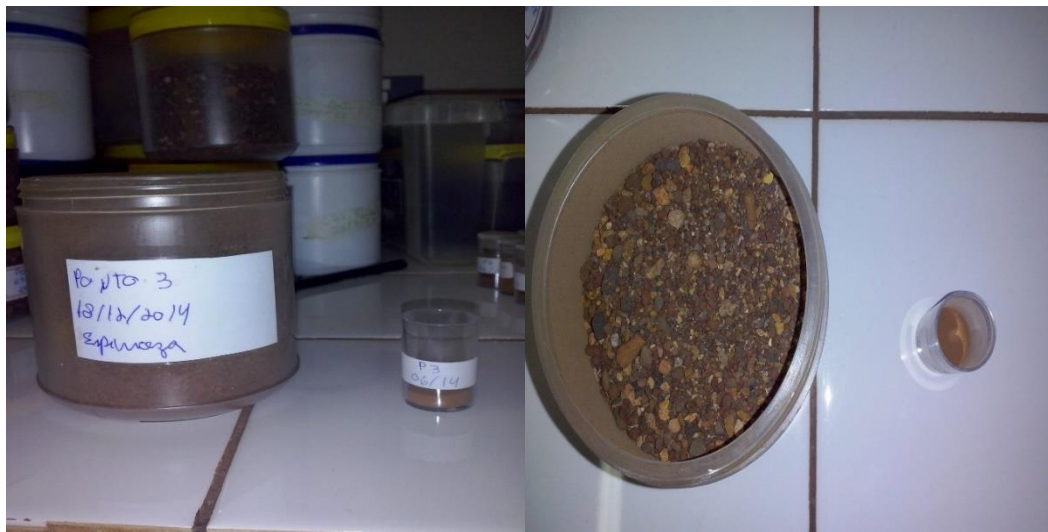
Figura 3.5 - Amostras de sedimento antes e depois da moagem.
