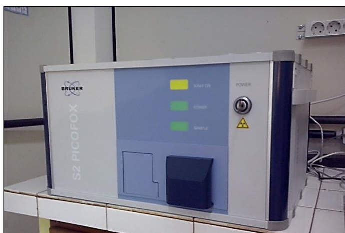
Figura 3.1 – TXRF modelo S2PICOFOX™ Da marca Bruker.
