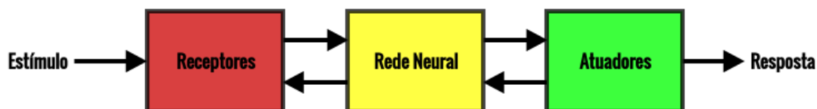
Figura 3.1: Representação em diagrama em blocos do sistema nervoso. Adaptado de (Haykin, 2001).
