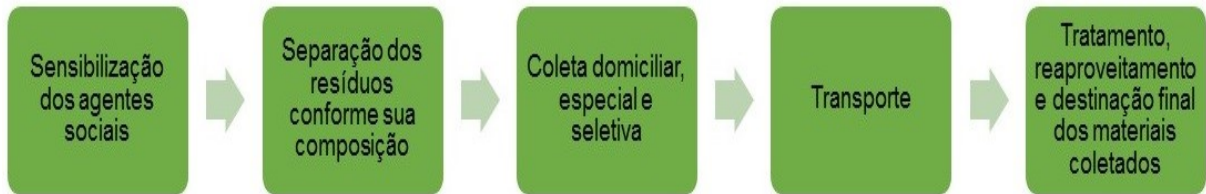
Figura 4: Etapas que compõem o gerenciamento dos resíduos sólidos Elaboração: Angela Danielle Kuhn, 2017.
