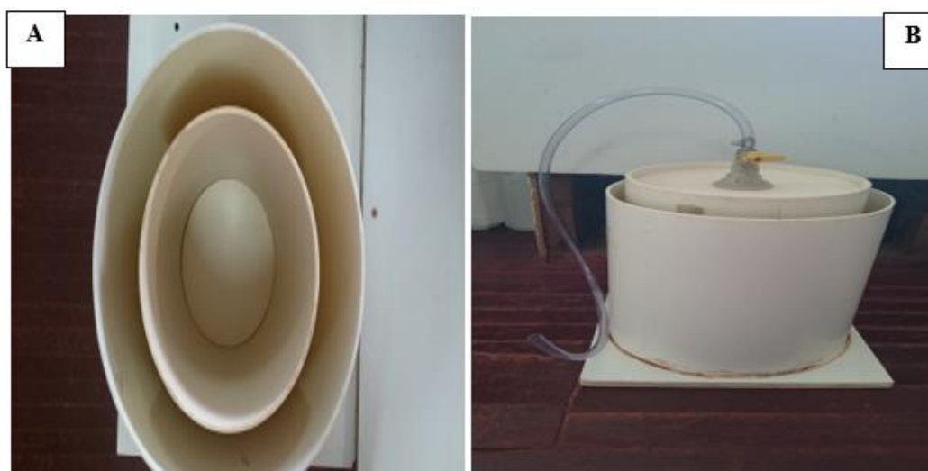
Figura 3: Biodigestor de Bancada Construído. A) Vista superior do Biodigestor. B) Biodigestor montado.
